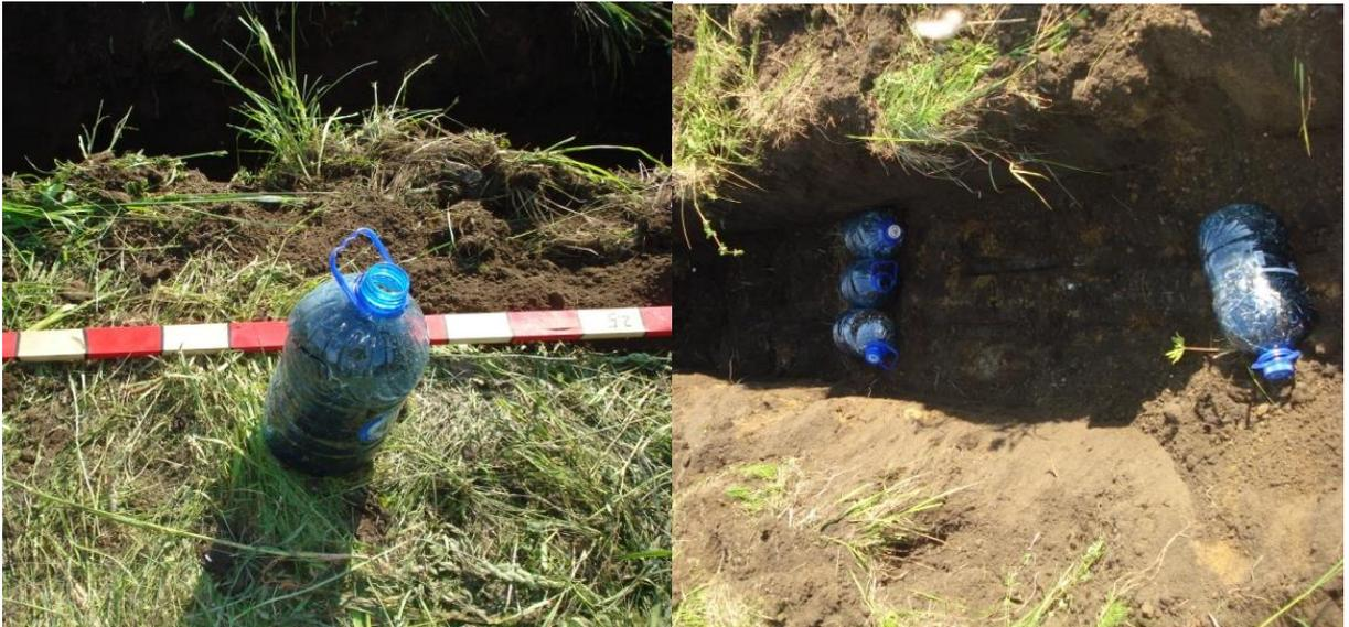
Рисунок 4 – Пластиковая бутылка 1 шт. (5 л) с металлической стружкой, глубина заложения 0.5 м
