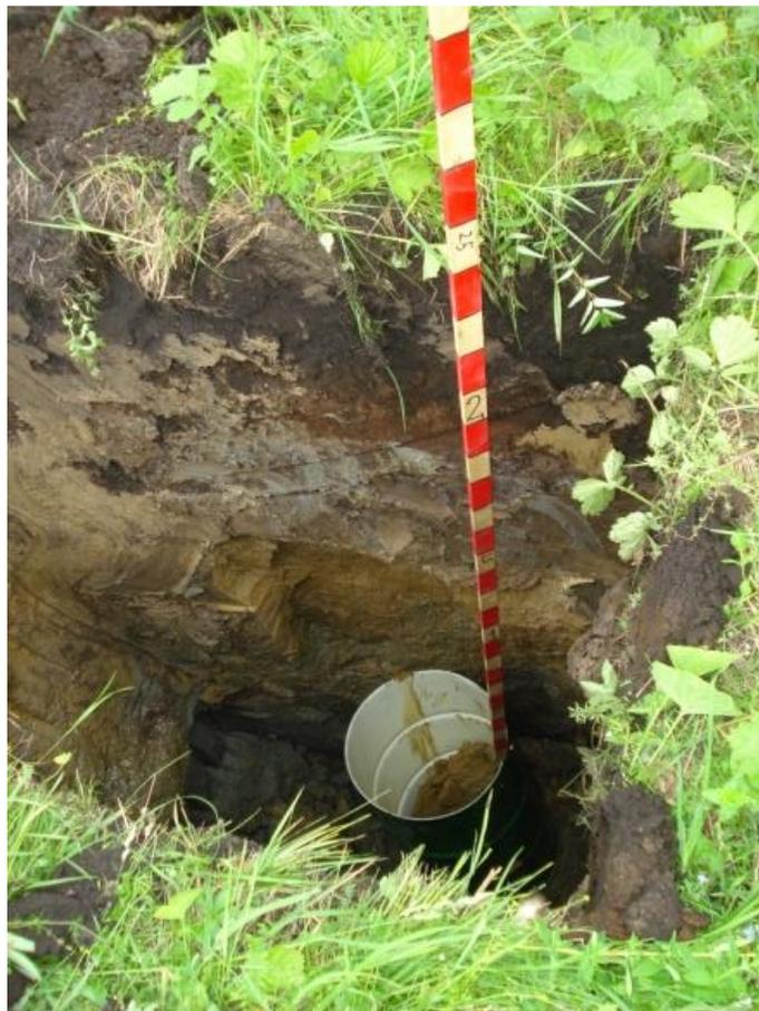
Рисунок 24 – Стальная бочка,  $D = 0.56$  м,  $H = 0.9$  м, глубина до верхней грани 2,5 м.
