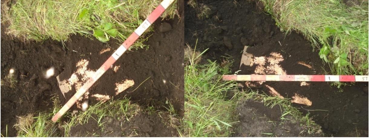
Рисунок 27 – Горизонтальный медный лист  $1.0 \times 0.6 \text{ м}^2$  под углом к осям, глубина заложения 0.8 м
