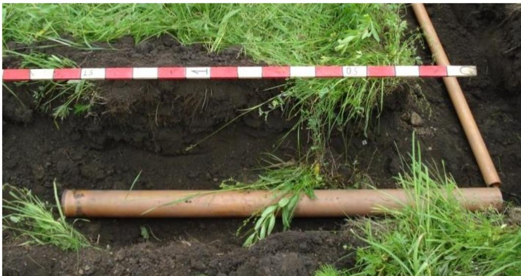
Рисунок 1 – Пластиковая труба длиной 1.8 м,  $D = 110$  мм, глубина заложения 0.5 м
