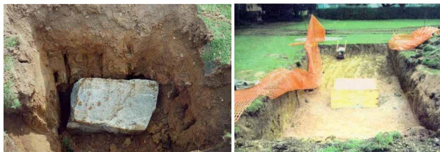
Рисунок 24 – Объекты полигона IGG Test Site (Лестерский Университет, Великобритания): большой булыжник, имитирующий контейнер с отходами (слева); погруженные в песок бетонные блоки (справа)
