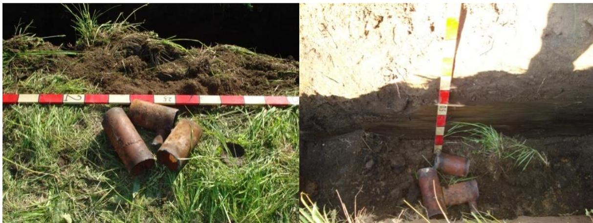
Рисунок 6 – Обрезки металлических труб ( $D = 100$  мм), размер объекта  $30 \times 30$  см<sup>2</sup>, глубина заложения 1.1 м
