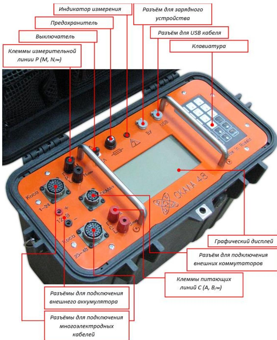
Рисунок 71 – Приборная панель, элементы управления и индикации, разъемы для подключения электроразведочных кабелей, проводов, зарядного и считывающего устройств
