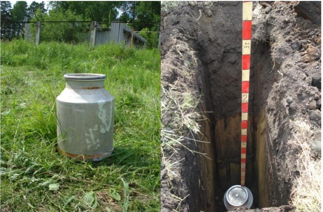
Рисунок 22 – Алюминиевая фляга,  $D = 0.35$  м,  $H = 0.5$  м, глубина до крышки 2.0 м
