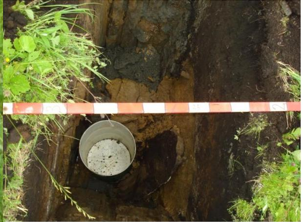
Рисунок 23 – Стальная бочка,  $D = 0.56$  м,  $H = 0.9$  м, глубина до верхней грани 0.9 м
