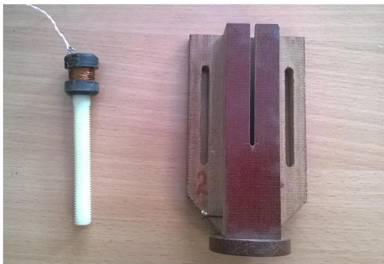
Рисунок 49 – Каркас приемной катушки и устройство для перемещения ее и фиксации при поиске минимума сигнала прямого поля
