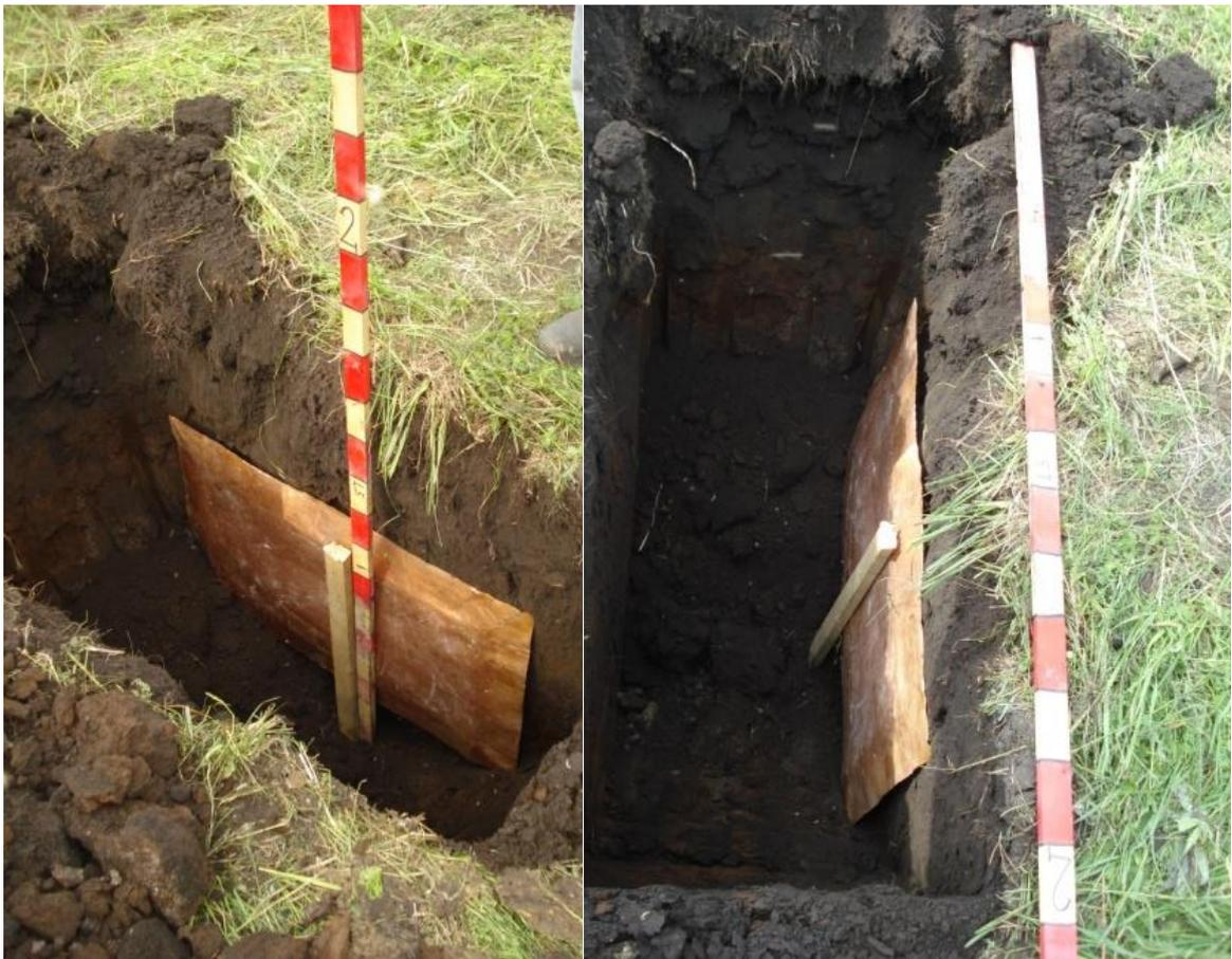
Рисунок 28 – Вертикальный медный лист  $1.0 \times 0.6 \text{ м}^2$ , глубина до верхней грани 0.45 м (лежит на стороне 1.0 м)
