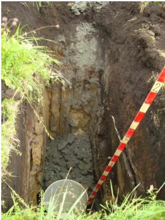
Рисунок 26 – Стальная бочка,  $D = 0.56$  м,  $H = 0.9$  м, глубина до верхней грани 1.8 м
