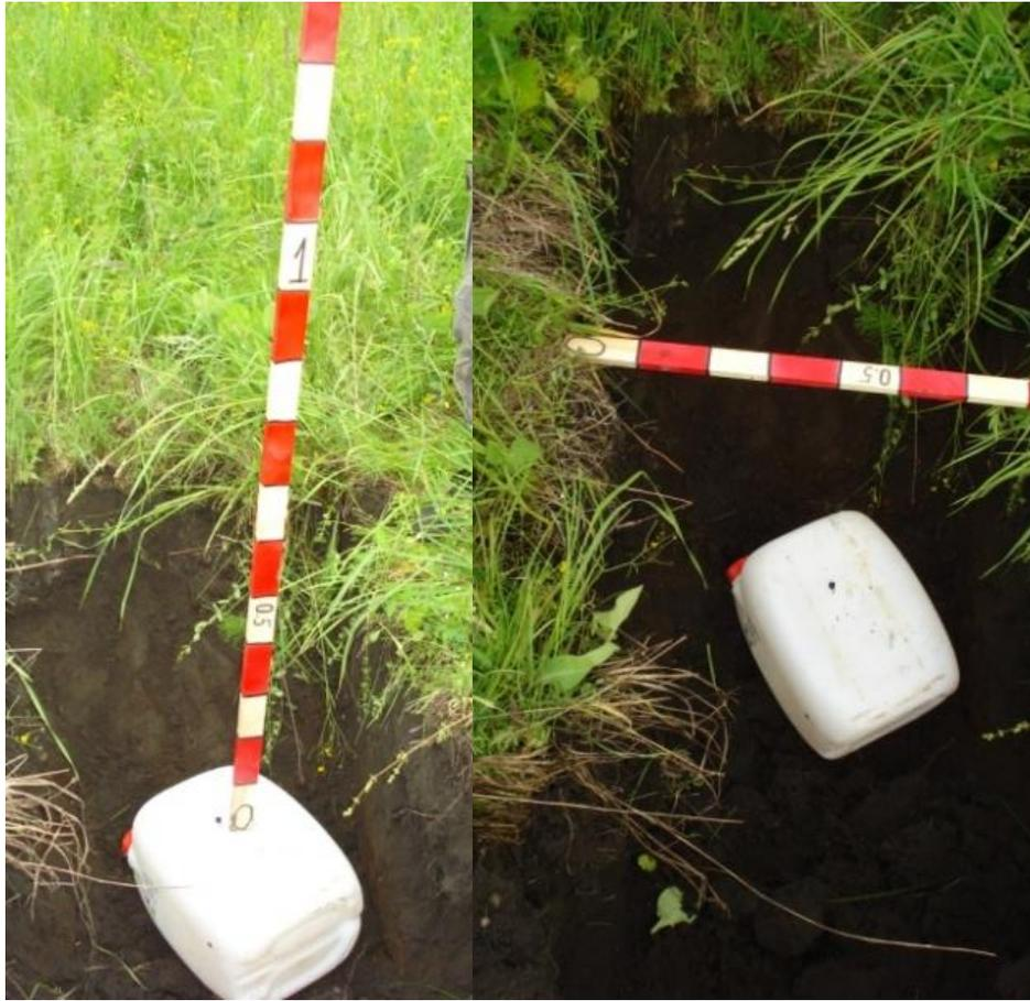
Рисунок 17 – Пластиковая канистра (1 шт), размер  $35 \times 25 \times 20$  см<sup>3</sup>, глубина заложения 0.5 м
