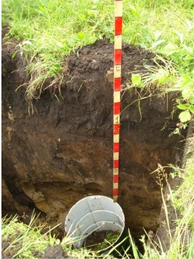
Рисунок 25 – Стальная бочка,  $D = 0.56$  м,  $H = 0.9$  м, глубина до верхней грани 1.3 м
