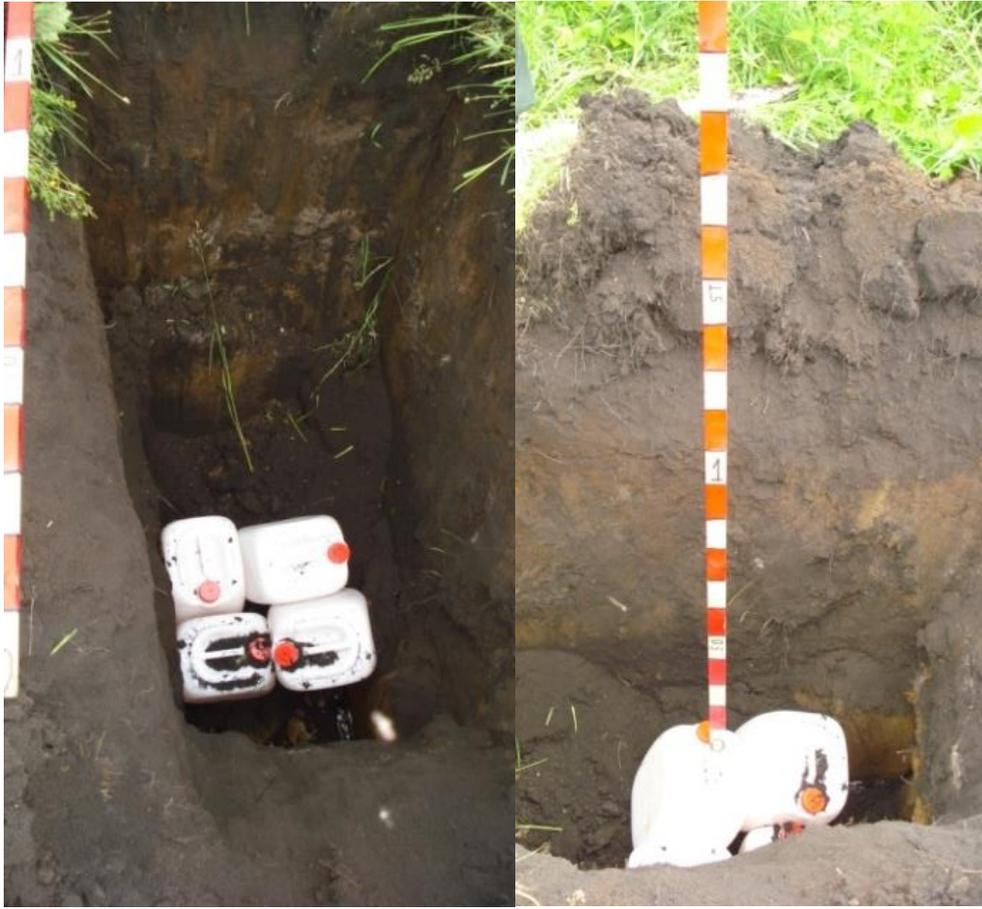
Рисунок 19 – Пластиковые канистры (4 шт), размер  $35 \times 25 \times 20$  см<sup>3</sup>, глубина заложения 1.5 м
