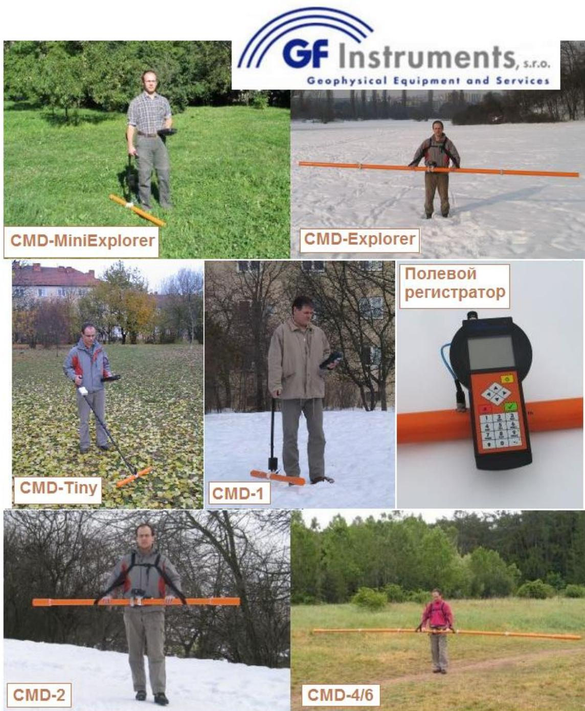
Рисунок 7 – Модификации аппаратуры для электромагнитного геометрического зондирования и электромагнитного профилирования компании GF Instruments (Чехия)
