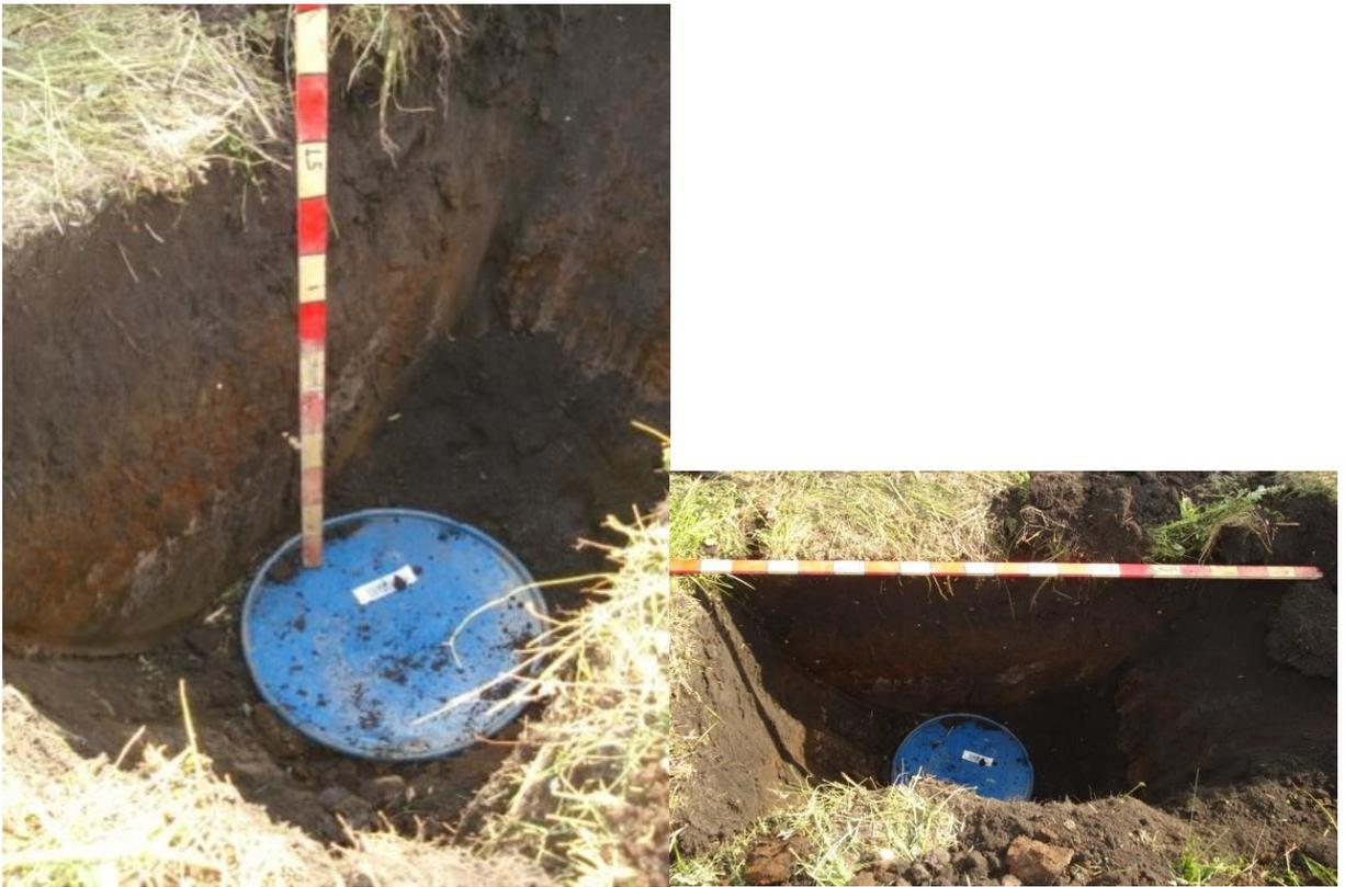
Рисунок 31 – Горизонтальный стальной круг,  $D = 0.6$  м, глубина заложения 1.0 м
