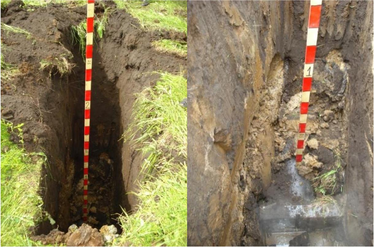
Рисунок 13 – «Авиационная бомба», стальная конструкция из трубы длиной 0.85 м,  $D = 0.3$  м и приваренной к ней подставке 0.55–0.65 м. высота подставки 0.1 м, глубина заложения 2.0 м
