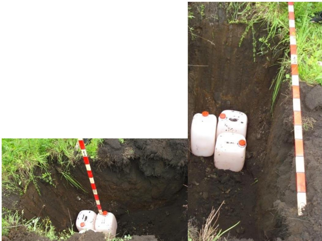
Рисунок 18 – Пластиковые канистры (3 шт), размер  $35 \times 25 \times 20$  см<sup>3</sup>, глубина заложения 1.0 м
