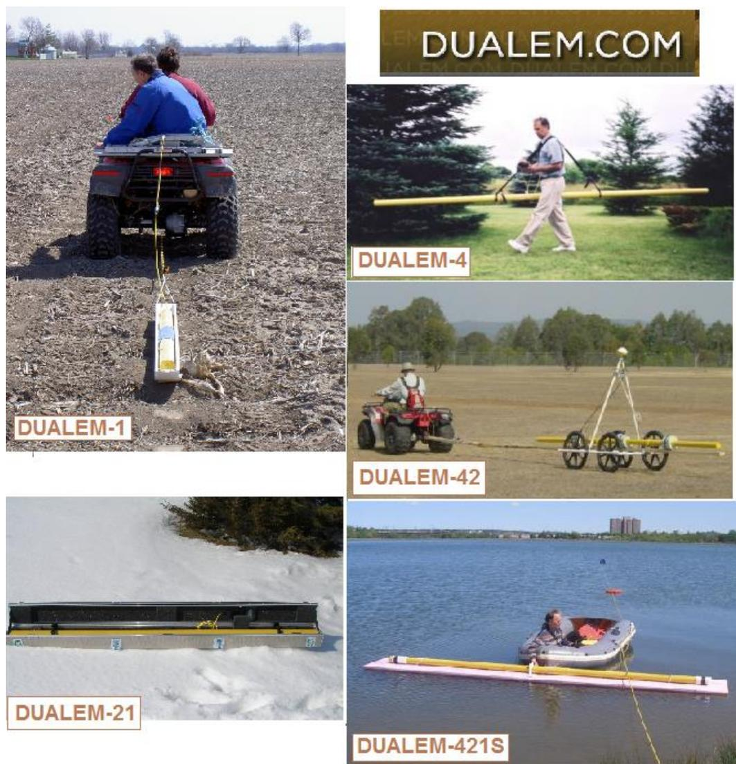
Рисунок 6 – Модификации аппаратуры для малоглубинного электромагнитного геометрического зондирования и электромагнитного профилирования компании DUALEM (Канада)
