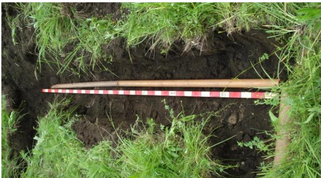
Рисунок 2 – Пластиковая труба длиной 3.7 м,  $D = 60$  мм, глубина заложения 0.5 м
