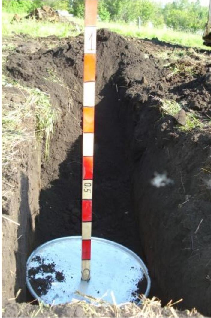
Рисунок 10 – Стальной круг,  $D = 0.6$  м, глубина заложения 0.5 м
