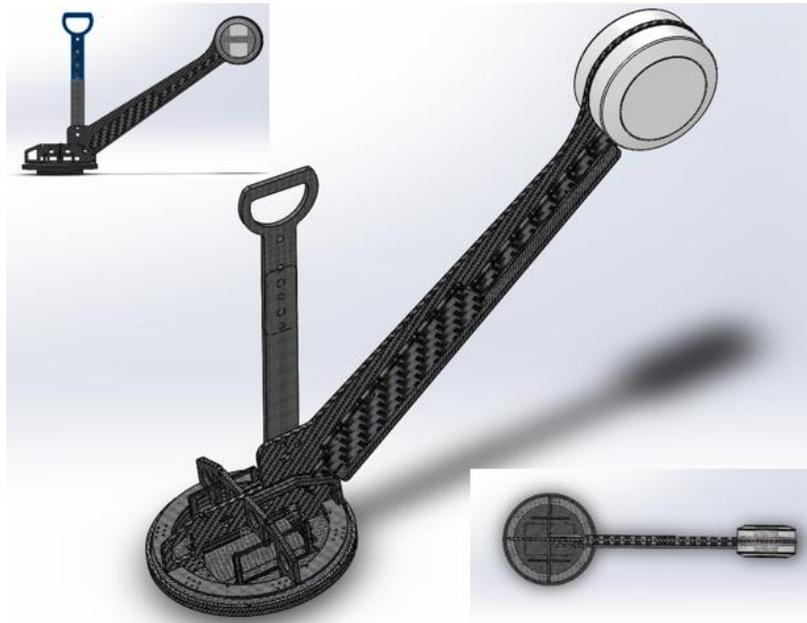
Рисунок 57 – Проект корпуса новой аппаратуры электромагнитного профилирования
