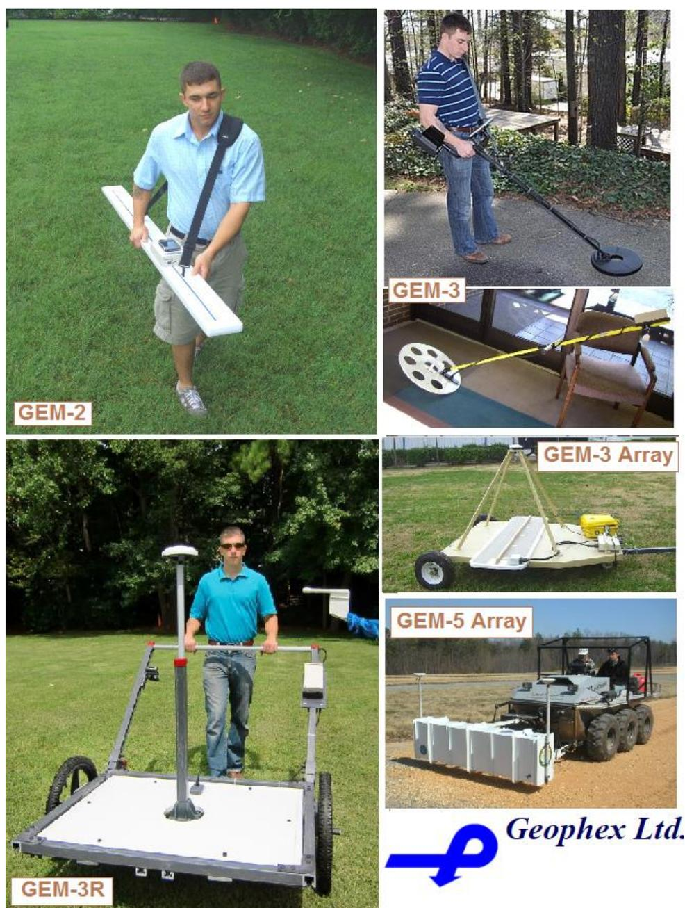
Рисунок 2 – Модификации аппаратуры компании Geophex Limited (США) для малоглубинного частотного электромагнитного зондирования и электромагнитного профилирования
