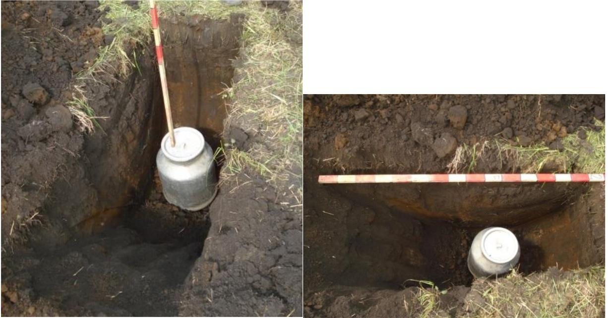
Рисунок 21 – Алюминиевая фляга,  $D = 0.35$  м,  $H = 0.5$  м, глубина до крышки 0.5 м
