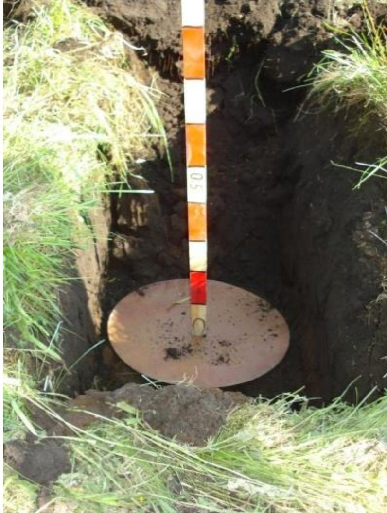
Рисунок 9 – Медный круг,  $D = 0.5$  м, глубина заложения 0.5 м
