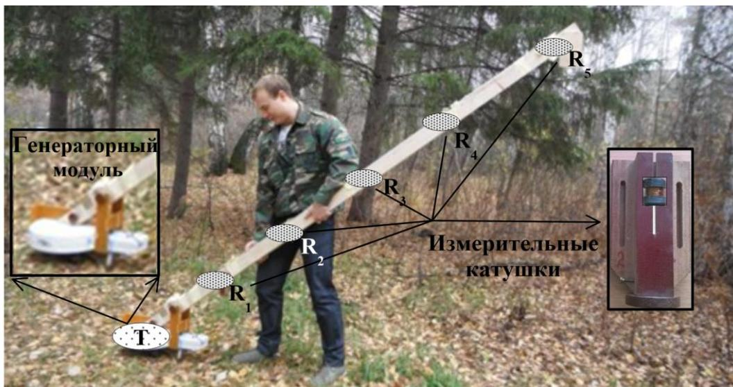
Рисунок 48 – Макет аппаратуры радиально-частотного зондирования
