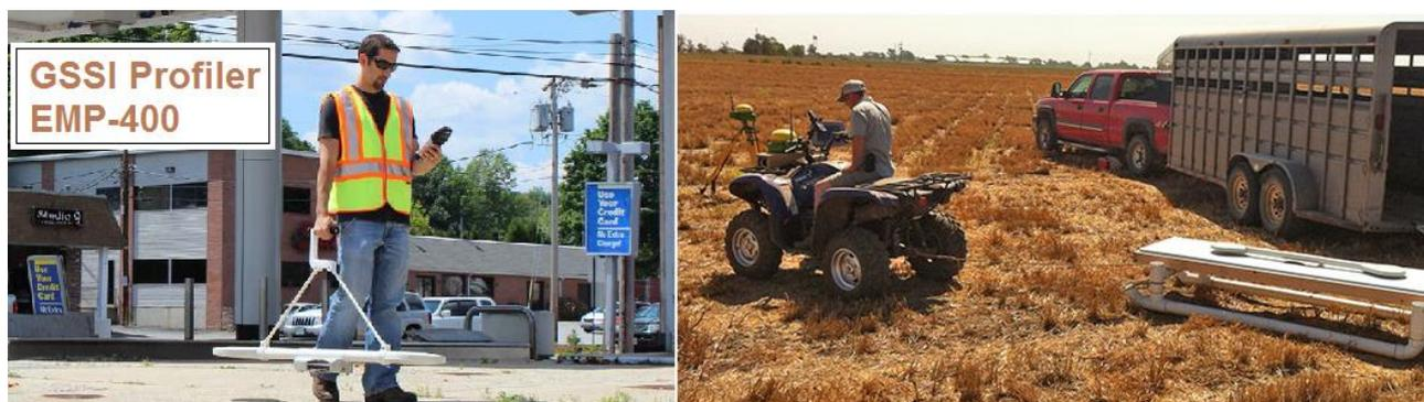
Рисунок 3 – Аппаратура EMP-400 для малоглубинного электромагнитного профилирования (GSSI, США)
