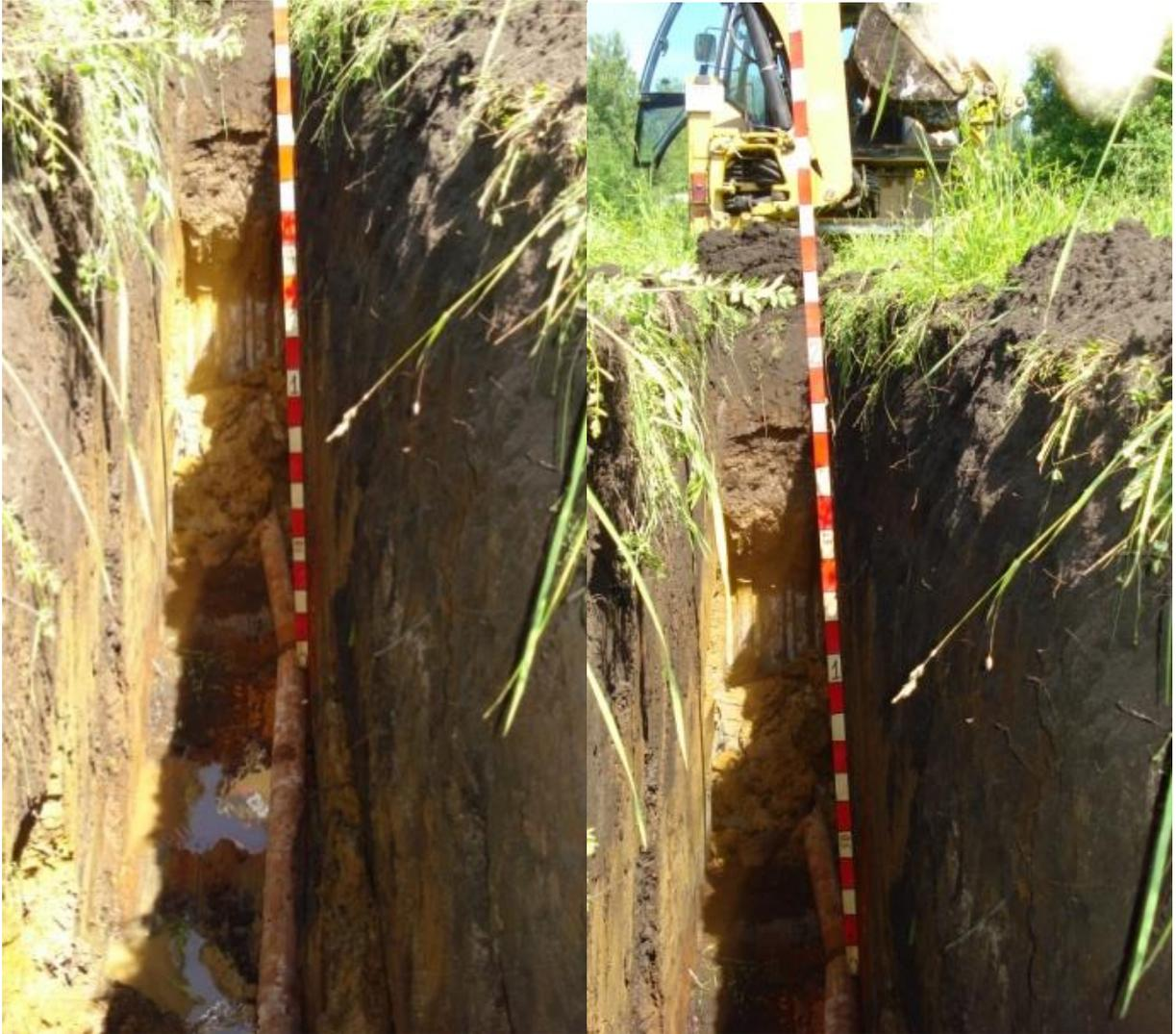
Рисунок 15 – Стальная труба длиной 5.0 м,  $D = 100$  мм, глубина заложения 2.0 м
