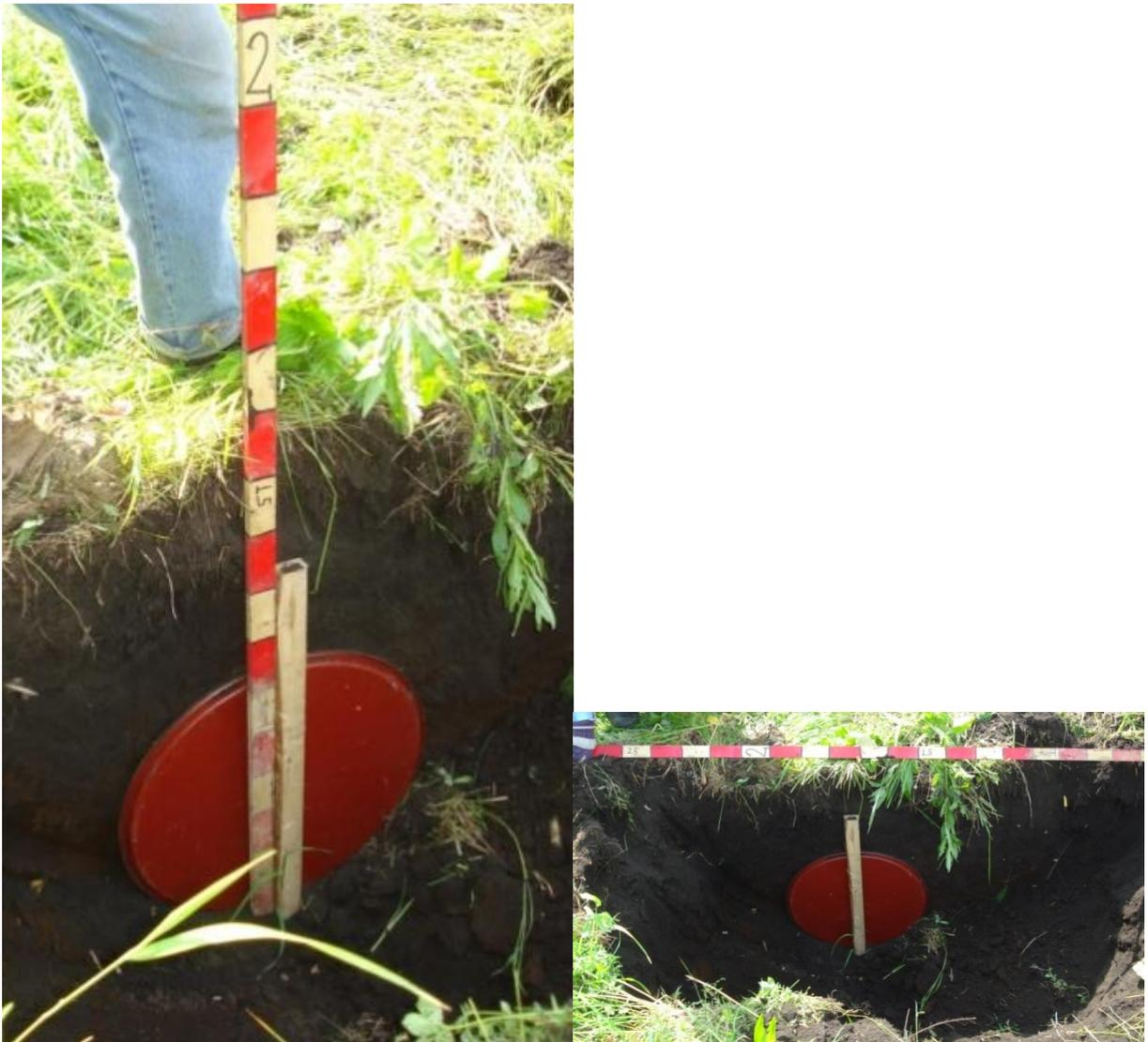
Рисунок 30 – Вертикальный стальной круг,  $D = 0.6 \text{ м}$ , глубина до верхней грани 0.5 м
