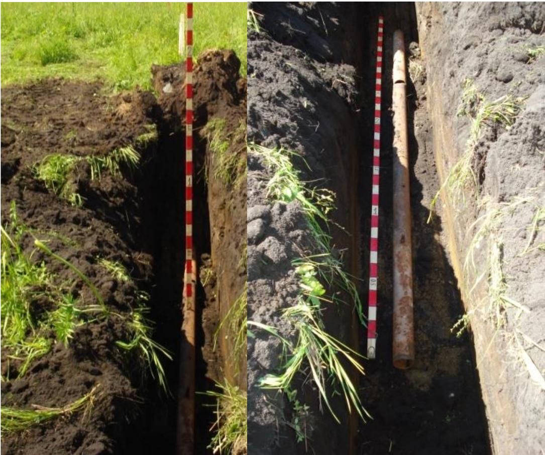
Рисунок 14 – Стальная труба длиной 4 м,  $D = 100$  мм, глубина заложения 1.0 м
