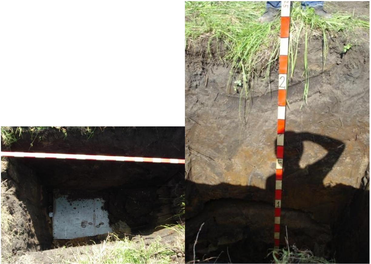
Рисунок 11 – Горизонтальный стальной лист  $1.0 \times 1.25 \text{ м}^2$ , глубина заложения 2.0 м
