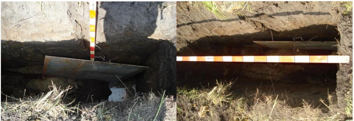
Рисунок 12 – Вертикальный стальной лист  $1.0 \times 1,25 \text{ м}^2$ , верхний край на глубине 1.0 м
